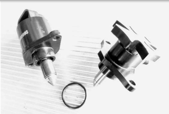
8 / Reinstalar la junta nueva sobre vuestro potato 2.0
