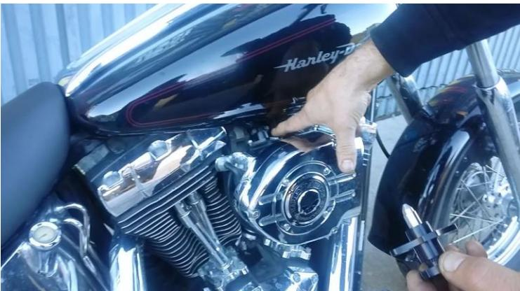
**WHEN DISASSEMBLING YOUR ORIGINAL SCREWS, FIRE UP YOUR VTWIN FOR A WHILE TO EXPAND THE ALUMINIUM; THIS WILL MAKE IT EASIER FOR YOU TO UNSCREW YOUR BOLTS AND AVOID BREAKING!!**
