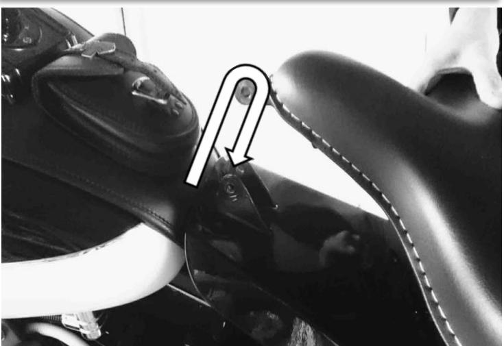
\*Al desmontar los tornillos originales, Arrancar el motor por un tiempo para expandir el aluminio, lo que tendrá el efecto de facilitar el desenroscado de los tornillos originales.
