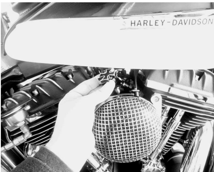
Lors du démontage de vos vis d'origine, faites tourner un instant votre moteur pendant quelques instants afin de dilater l'aluminium ; Ce qui aura pour effet de vous faciliter le dévissage de vos boulons d'origine et ainsi **ÉVITER de les casser !!!** car ils sont montés au du frein filet et sont de mauvaise qualité / Le pourquoi nous vous les remplaçons par de la visserie en Inox.
