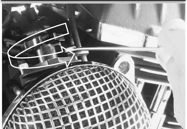
11 / Aísle el conector de 4 clavijas con el conector a prueba de agua. Atar todo bajo el tanque.
